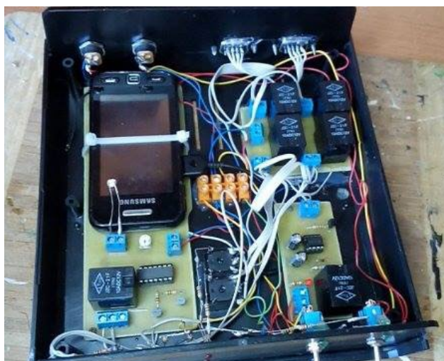
Konstrukcja „czarnej szkatki” w wersji z telefonem komórkowym
