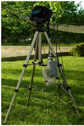
Zestaw do obserwacji fotograficznych meteorów Foto: PKiM
